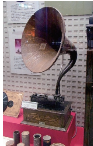
図6 蓄音機。ホーンの形や大きさと音を大きくするには限界がある。
