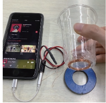
図2 手作りスピーカー。コイルをマイク端子につなげばマイクにもなる。
