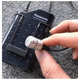
図4 コンデンサーマイクとそのしくみ。プラスの電気を帯びた振動膜のふるえにあわせて、そのプラスの電気に引き付けられたマイナスの電気が固定電極に流れこんだり反対に流れだしたりする。
