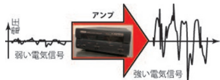
図7 弱い電気信号を強くするのがアンプ。
